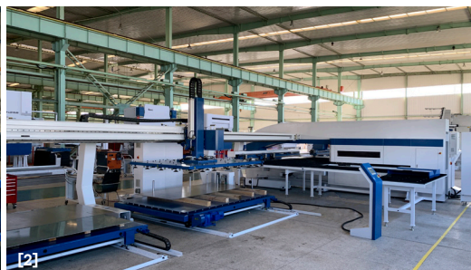
[1] Presse plieuse PRO bend 160.41 7 axes. [2] Poinçonneuse électrique EXPERT Punch 30.22. [3] Pièces SAG France.
