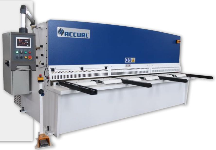
Les cisailles pendulaires permettent de couper avec un faible angle de cisailage, ce qui a pour effet de réduire la déformation des tôles fines. L'angle de cisailage reste fixe, seul le jeu entre lames varie en fonction du type et de l'épaisseur de la matière à cisailer.
