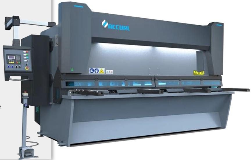
Les guillottes EXPERT Cut permettent de couper les tôles avec un angle de coupe variable ce qui permet d'obtenir un résultat optimal selon les épaisseurs et la qualité de la matière. L'angle de coupe et le jeu entre lames sont pilotés par la commande numérique.
